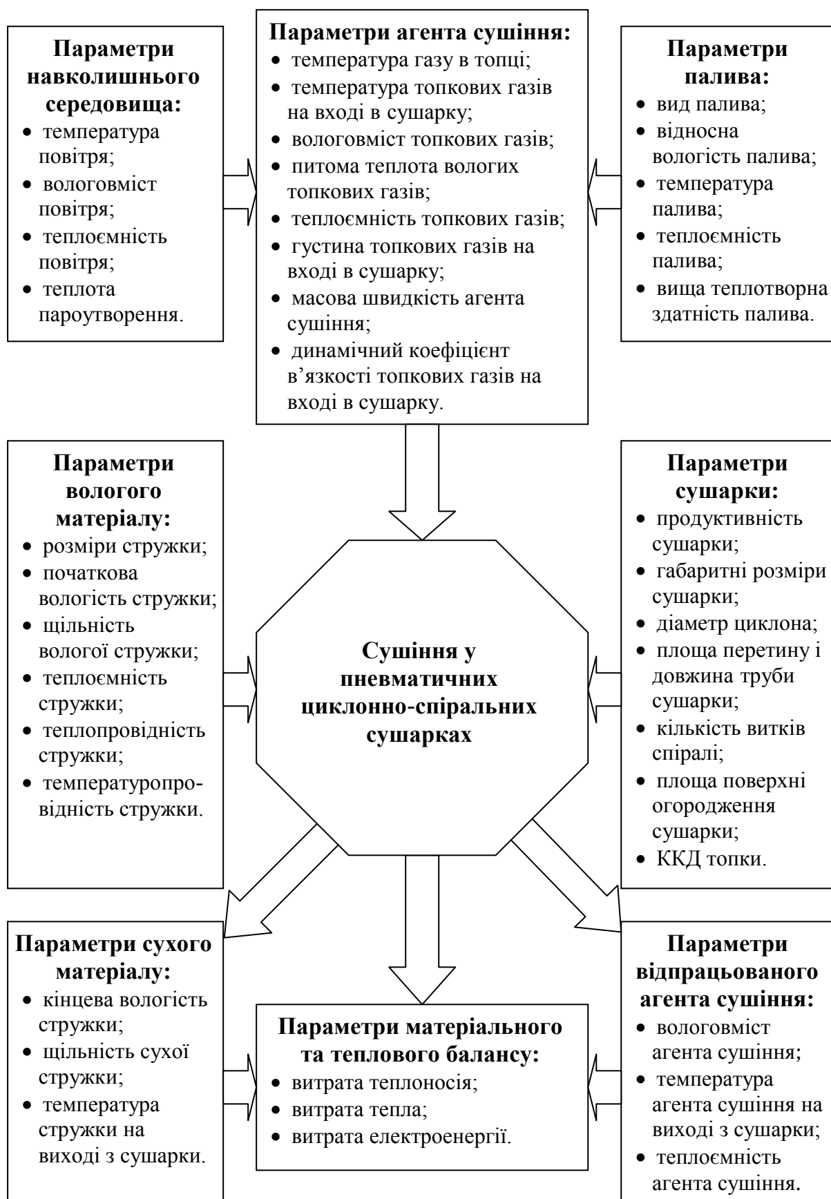
Рис. 1. Структурна схема процесу сушіння стружки у пневматичних циклонно-спіральних сушарках
