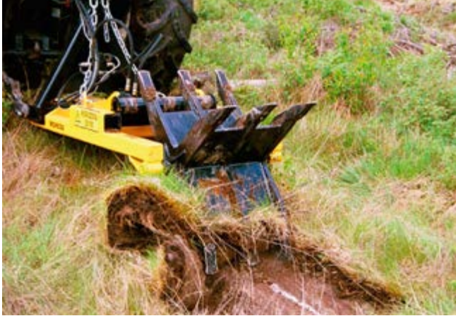
Рис. 2. Розпушення поверхні ґрунту спеціальним культиватором "Kulla" [17]
