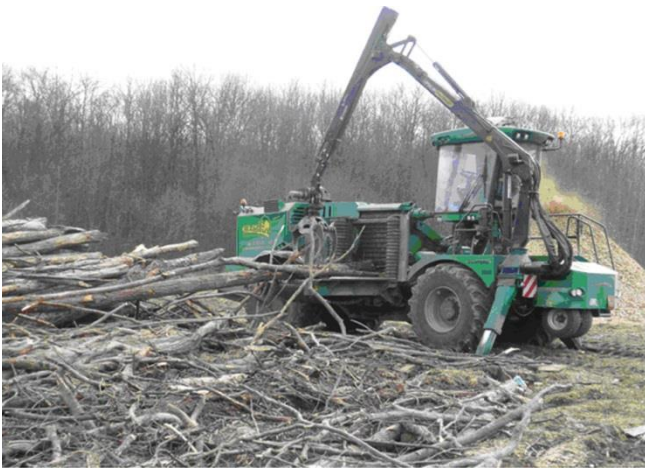
Рис. 3. Виготовлення паливної тріски мобільною рубальною машиною
