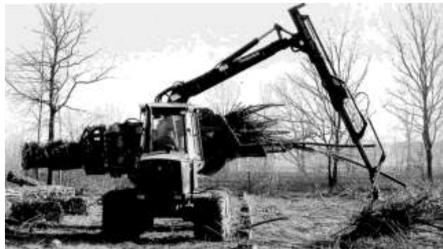
Рис. 5. Пакетування біомаси дерев на енергетичній плантації
