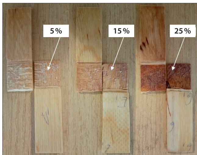
Рис. 1. Зразки фанери, склеєної зі шпону, модифікованого розчином лимонної кислоти різної концентрації
