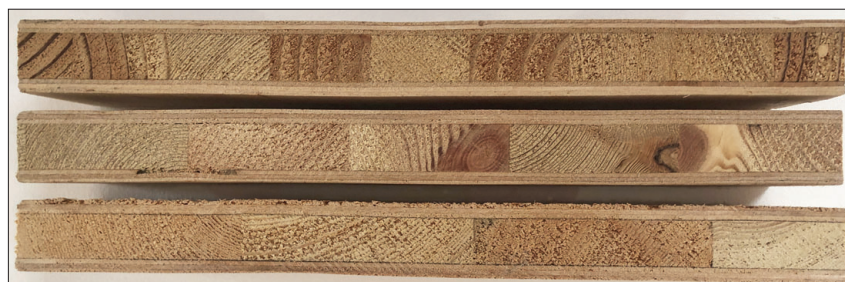
Рис. 1. Конструкції звичайної СП із ВЖД товщиною 22 мм з шириною рейок 32, 52 та 72 мм зі склеєними рейками та личкованих фанерою з двох боків товщиною 3 мм
