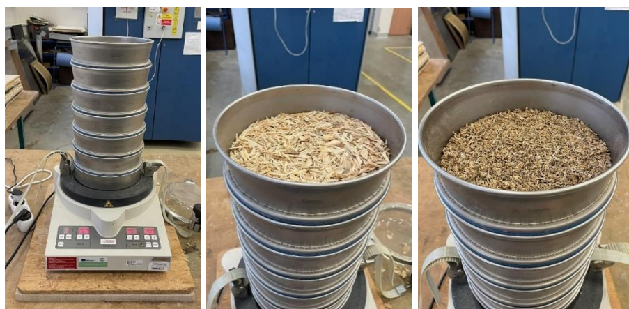
Рис. 5. Аналіз фракцій частинок за допомогою вібраційного сита Fritsch Analysette 3
