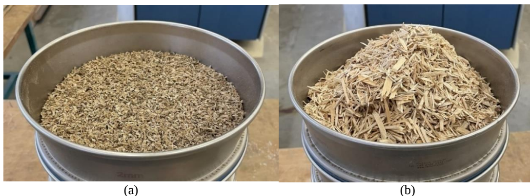
Рис. 3. Жом цукрового буряка (а) та деревинні частинки (б), що використовували для виготовлення стружкових плит
