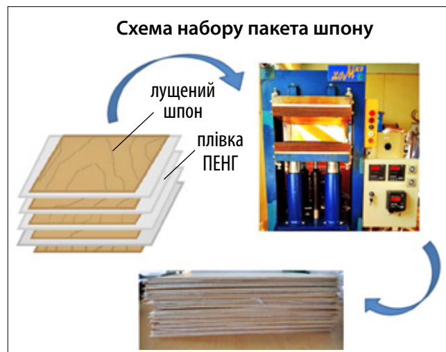
Рис. 2. Технологічний процес формування пакета шпону та його пресування
