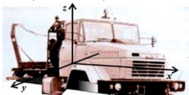
Рис. 1. Підресорена маса лісовозного автомобіля і система координат, в якій можливі коливання
