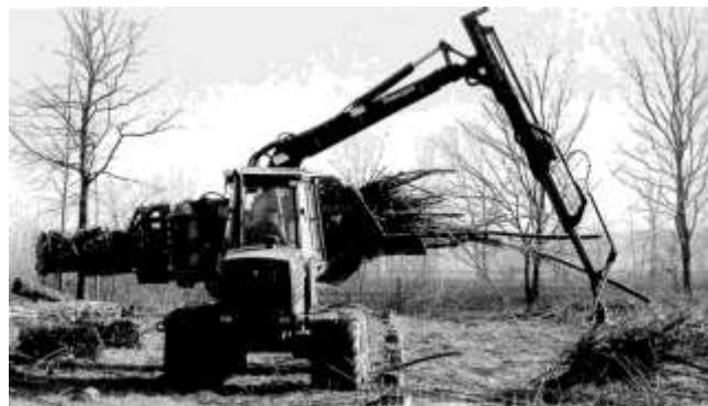
Рис. 5. Пакетування біомаси дерев на енергетичній плантації
