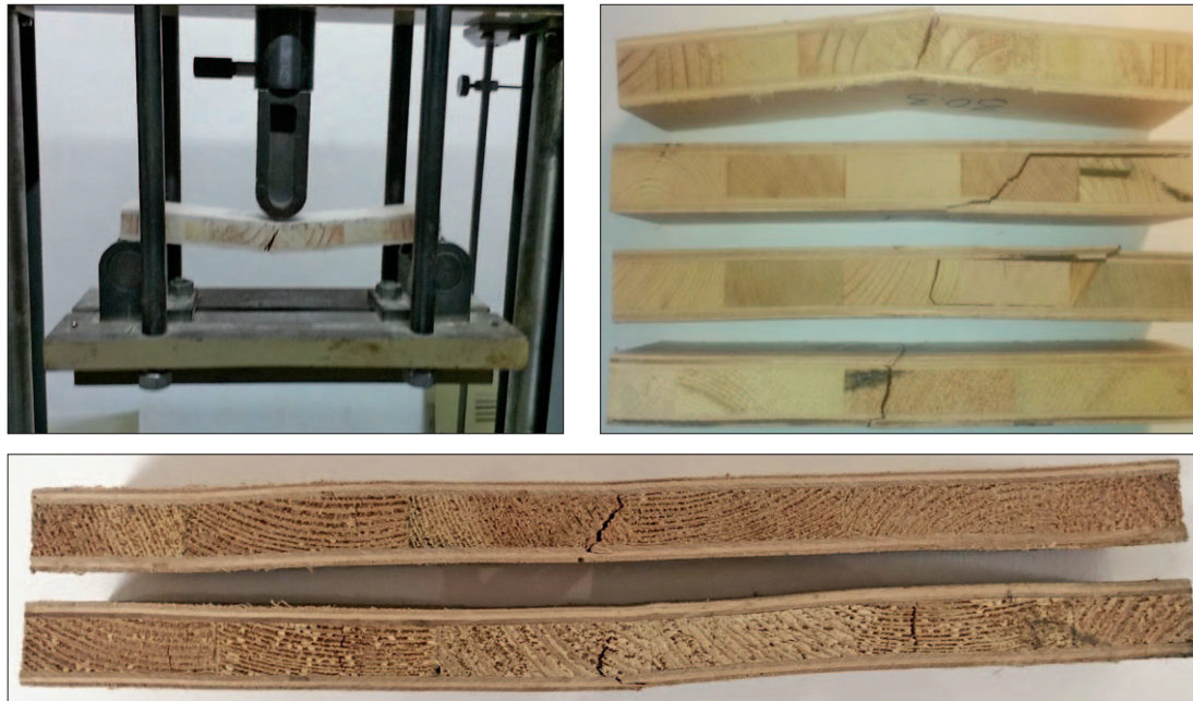
Рис. 2. Випробуваний зразок зі столярним щитом із ВЖД сосни, що личкований фанерою в момент тестування Fig. 2. Test specimen with a block board made from a pine PCW which was faced with plywood at the time of testing (of breakage)
