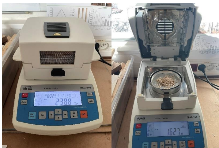
Рис. 4. Вимірювання вмісту вологи за допомогою аналізатора вологості RADWAG MAC 210
