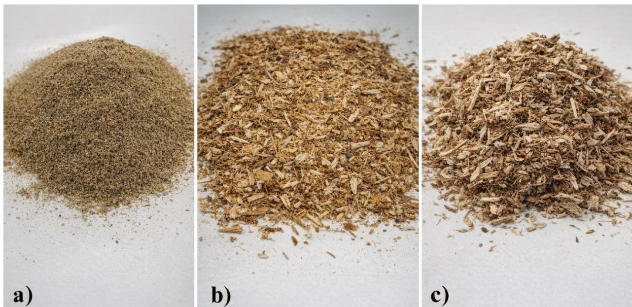
Рис. 2. Частинки використовувані для виготовлення плит: деревинна стружка для зовнішніх (а) і внутрішнього шарів (б); частинки костриці конопель для внутрішнього шару (с)
