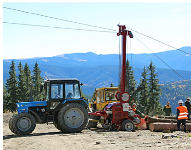
Рис. 5. Причіпна мобільна канатна установка MOZ-300
