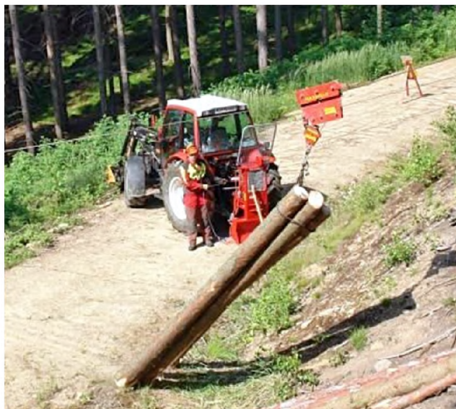
Рис. 3. Легка мобільна канатна установка «MAXWALD»
