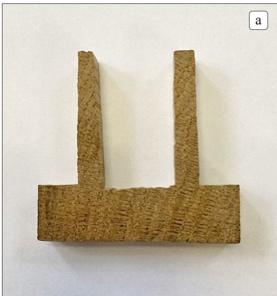
Рис. 2. Секція для дослідження умовного показника залишкових напружень: а – випиляна секція; б – схема розкрою секцій напружень для пиломатеріалів (заготовок) за товщини більше 40 мм:
