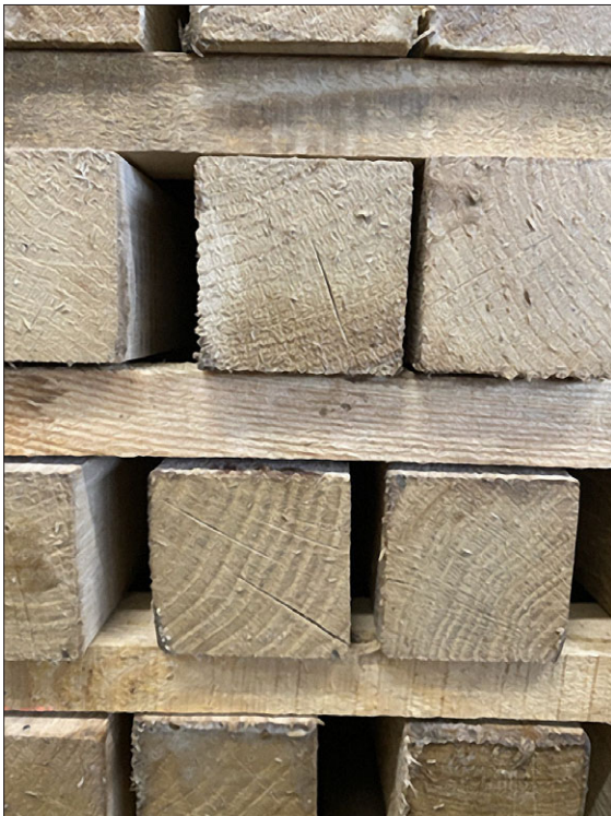
Рис. 8. Торцеві тріщини в заготовках з дерева дуба
