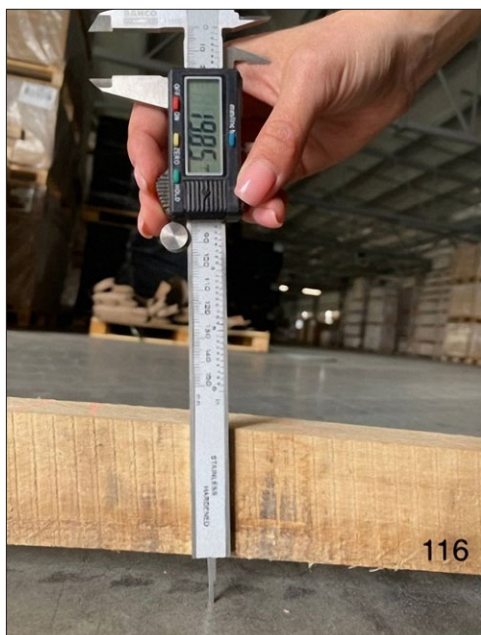
Рис. 3. Вимірювання стріли прогину заготовки Fig. 3. Measuring the deflection of the blank
