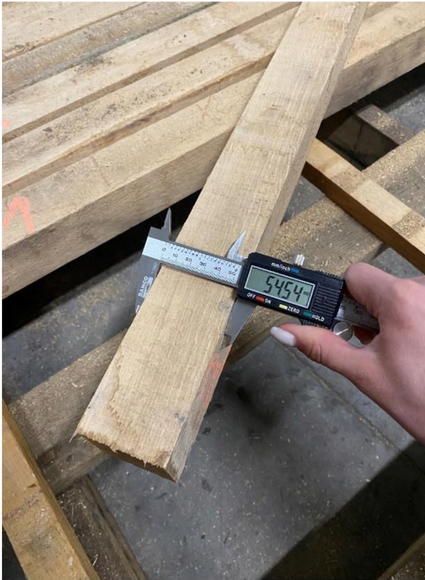
Рис. 1. Вимірювання лінійних розмірів дубових заготовок
