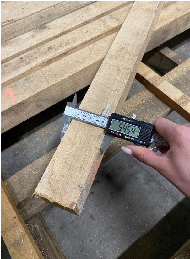
Рис. 1. Вимірювання лінійних розмірів дубових заготовок
