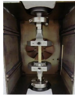
Рис. 2. Система кріплення зразків для вимірювань повзучості
