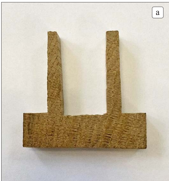
Рис. 2. Секція для дослідження умовного показника залишкових напружень: а – випилювана секція; б – схема розкрою секцій напружень для пиломатеріалів (заготовок) за товщини більше 40 мм:
