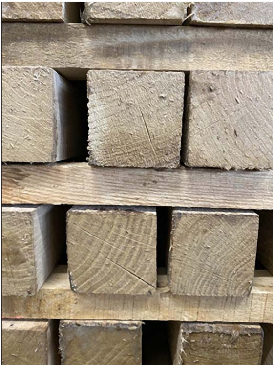
Рис. 8. Торцеві тріщини в заготовках з дерева дуба
