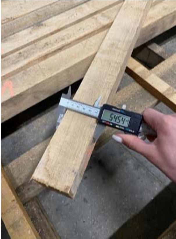
Рис. 1. Вимірювання лінійних розмірів дубових заготовок
