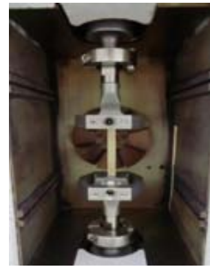
Рис. 2. Система кріплення зразків для вимірювань повзучості
